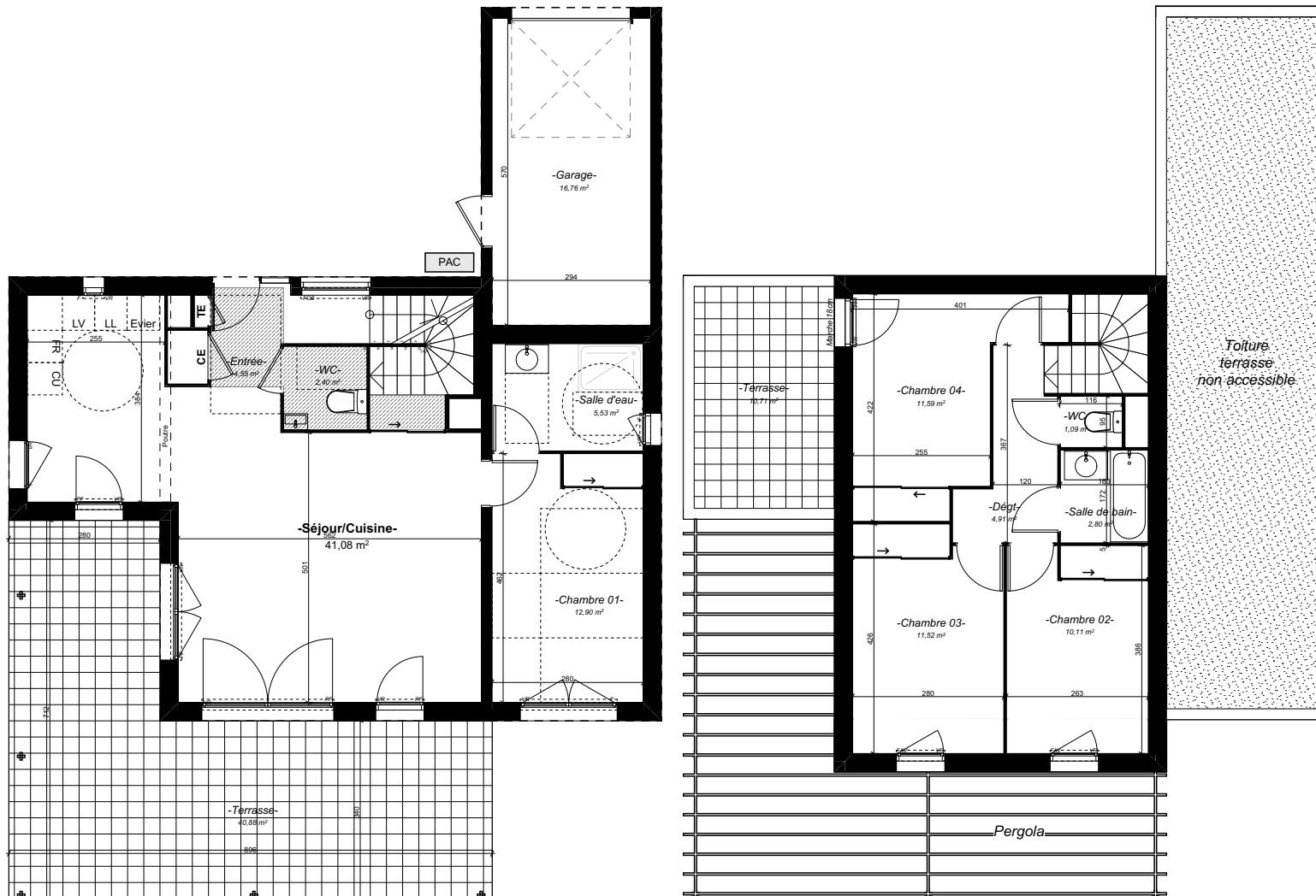
VR volet / rouant / VB volet battant / FAV fenêtre allégée vitrée / PF porte fenêtre / F fenêtre / FOB fenêtre oscille-battante / GG garde corps / TE tableau électrique / LL lave linge / LV lave vaisselle / FF frétil / CU cuiseur / TRV tri / PL placard / M meuble / CE chauffe-eau / masquette / fiva plafond /  servitude / canal de Provence
