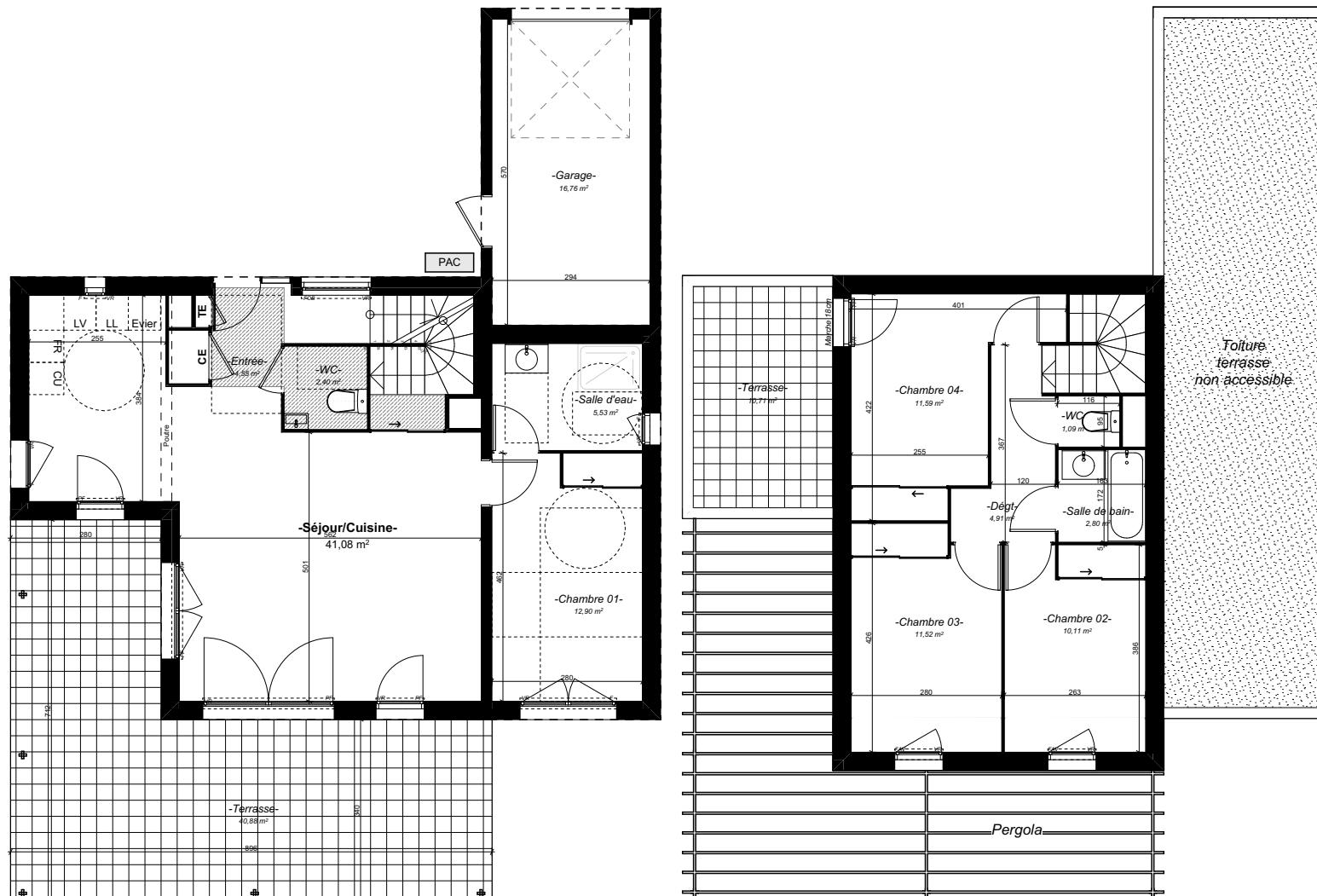
VR volet roulant / VB volet battant / FAV fenêtre allège vitrée / PF porte fenêtre / F fenêtre / FOB fenêtre oscillo-battante / GC garde corps / TE tableau électrique / LL lave linge / LV lave vaisselle / FR froid / CU cuisson / TRI tri / PL placard / M meuble / CE chauffe-eau / ☐ masquette, faux plafond / ☒ servitude du canal de Provence
